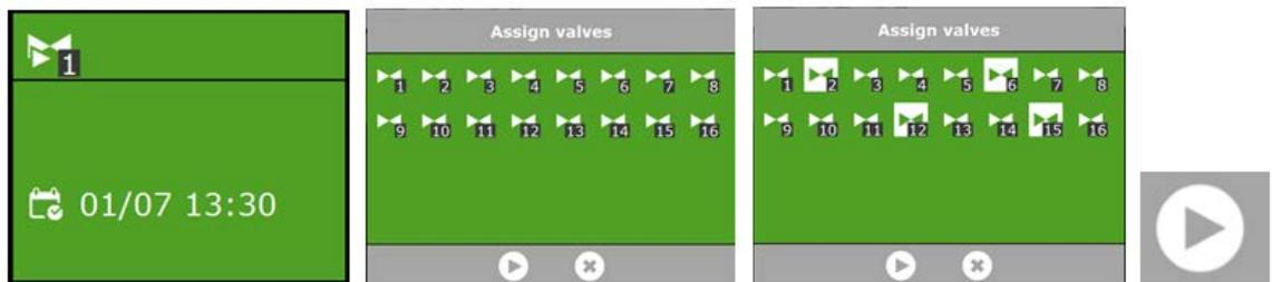
Se viene eseguito un avvio manuale del gruppo valvole, il programma di irrigazione attiverà le valvole assegnate al gruppo e applicherà la ricetta preconfigurata. Il programma di avvio si trova sul lato destro della barra superiore . È possibile attivare un gruppo di valvole toccando il pulsante "Play" nella schermata di attività del gruppo valvole. Il gruppo valvole verrà immediatamente attivato.
