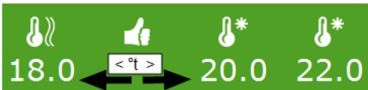
Quando la temperatura scende sotto 18,0°C inizia la prima fase di riscaldamento. Quando la temperatura supera i 20,0°C inizia la prima fase di raffreddamento. Quando la temperatura supera i 22,0°C inizia la seconda fase di raffreddamento.
